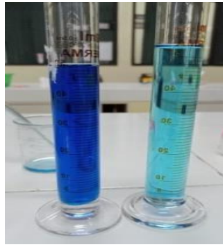
Gambar 7. Perbedaan larutan metilen biru sebelum dan setelah di filtrasi menggunakan membran kitosan
