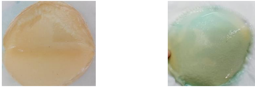
Gambar 5. Membran kitosan sebelum (kiri) dan setelah (kanan) dilakukan pengujian permeabilitas
