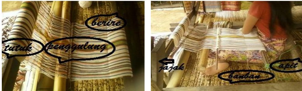
Gambar 2 Fungsi bagian alat Tenun dan posisi dari seorang penenun
